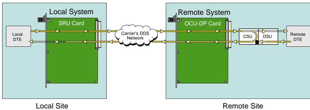
Figure 2-7. Inband Remote CSU Loopback
