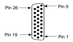
Figure 1-8. HSU-AD 530/35 Card Jack Pin Orientation
